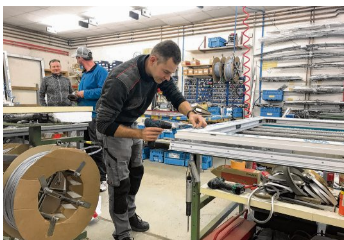
Ein wichtiges Standbein in der Bauschlosserei Kobs ist der Fensterbau. Hier entsteht unter den geschickten Händen von Mitarbeiter René Lindner ein neuer Rahmen. FOTOS: TOBIAS LEMKE
